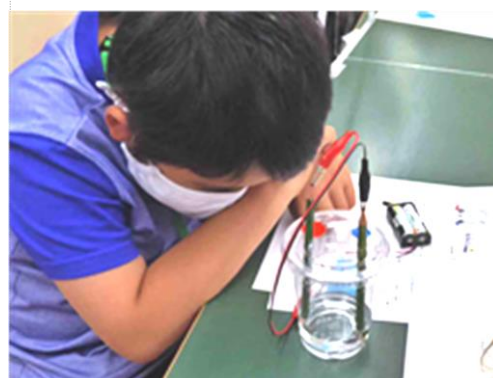
水の電気分解で水素と酸素の気泡を確かめた
