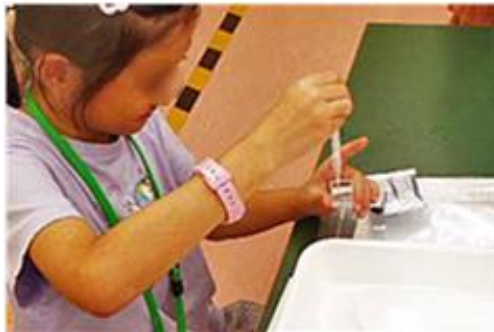
パックテスト用に、調べる水を吸取る
